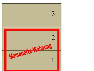
**Fall 3 – Erschließung eines dreigeschoßigen Gebäudes erfolgt im mittleren Geschoß:** Da in Bezug auf den Gebäudeeingang (roter Pfeil) nur jeweils eine Erschließungsebene existiert (eine Ebene nach oben und eine Ebene nach unten), besteht in diesem Fall **keine Aufzugsverpflichtung**.
