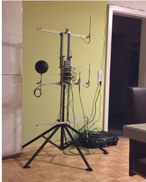
Abb. 72 Behaglichkeitsmessbaum während der Spotmessung A, Fernwärme-Wohnung
